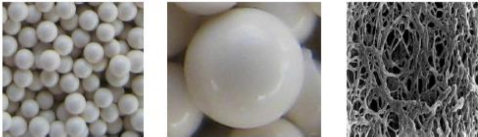
图 3：吸附分离树脂外观及微观结构图
